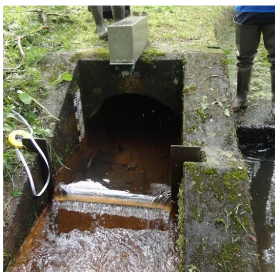
Figure 22 - Seuil et échelle de niveau à la restitution à l'Avière
