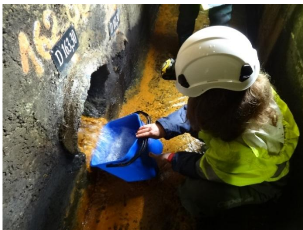
Figure 24 - Mesure par empotage des débits à l'exutoire du joint de dilatation droit
